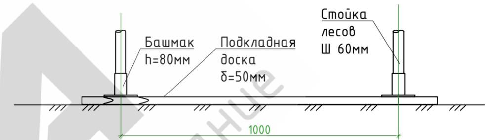
Схема расположения рамных лесов на твердом основании
